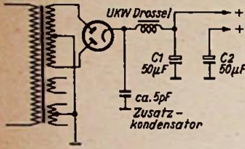
Netzbrummen im UKW-Bereich läßt sich manchmal durch einen kleinen Zusatzkondensator beseitigen
