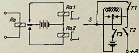
Bild 18. Pulsatorsteuerung mit zwei Funktionen
