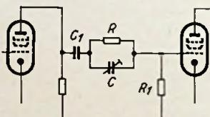
Bild 189. Frequenzabhängiger Spannungsteiler zur Anhebung der hohen Frequenzen
