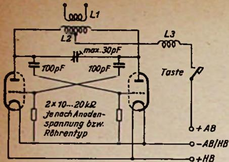
**Bild 1. Gegentakt-Hf-Sender.** L1 = 3 Windungen Cu versilbert, 2 mm Ø; Spulenkörper 18 mm Ø, 8 mm lang; L2 = 12 Windungen Cu versilbert, 2,5 mm Ø; Spulenkörper 18 mm Ø, 45 mm lang; L3 = Hf-Drossel, Drahtlänge = 1/4. Geeignete Röhren: 3 A 5, (1,5 W), 2 x RL 2,4 T 1, LS 2, RL 2,4 T 4 (3...4 W)
