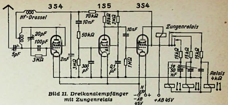
Bild 11. Dreikanalempfänger mit Zungenrelais
