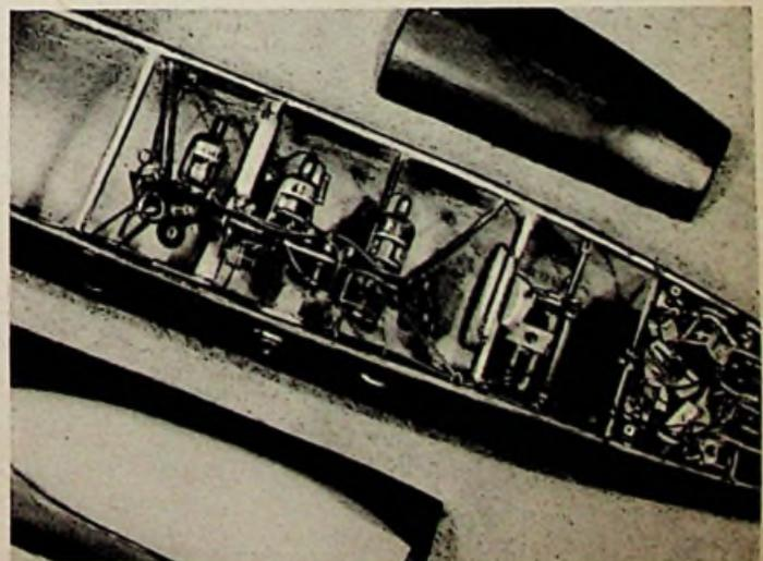
Bild 13. Gesamtansicht der Dreiröhrenempfangsanlage mit Empfängerrelais und Batterieteil im Bug eines Modellflugzeuges mit Motorantrieb
