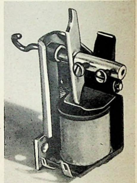
Bild 25. Ansicht eines zweiarmigen Schrittwechslers
