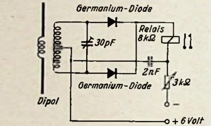
**Bild 5. Einfacher Empfänger mit zwei Germaniumdioden für Entfernungen bis zu 100 m**
