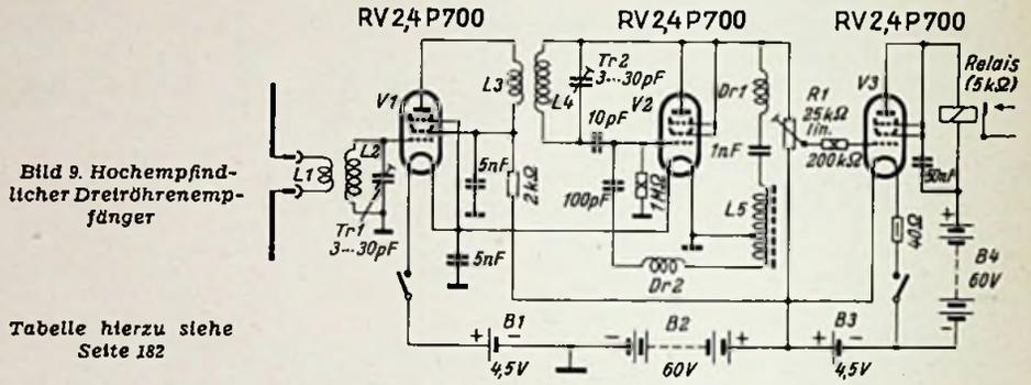
Bild 9. Hohempfindlicher Dreiröhrenempfänger
