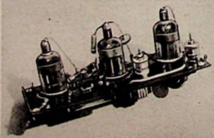
Bild 10. Ansicht der Empfängerplatte des Dreiröhrenempfängers
