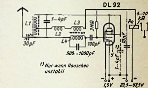
**Bild 6. Empfänger mit Pendelfrequenz-Transformator.** L1 = 18 Windungen CuL, 0,3 mm Ø auf Hf-Kern 10 mm Ø, Anzapfung an der 7. Windung; L2 = Hf-Drossel. Drahtlänge = 1/4; L3 und L4 = Pendelfrequenz-Transformator
