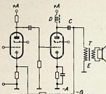
Drossel D zur Beseitigung einer Vormagnetisierung und zur Herabsetzung des Netzbrummens
