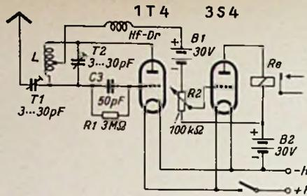
Bild 8. Einfacher Zweiröhrenempfänger
