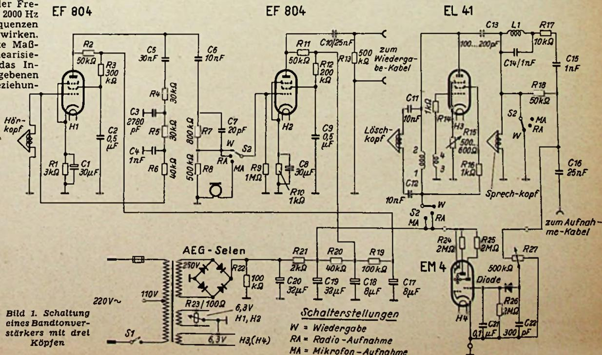
Bild 1. Schaltung eines Bandtonverstärkers mit drei Köpfen
