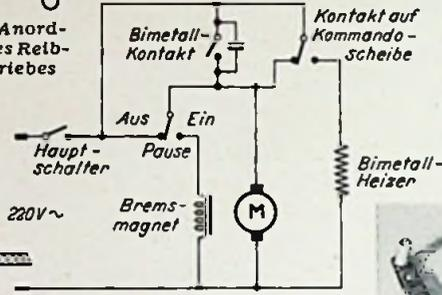
Bild 4. Der Motorstromkreis
