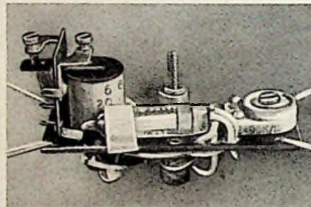
Bild 24. Einröhrenempfänger mit dem Schrittwechsler von Bild 23. Gewicht des gesamten Empfängers = 45 g (F. Tröger, Fürstfeldbruck)
