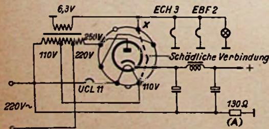
Brummfehler durch eine innere Verbindung an den Sockelstiften einer Gleichrichterröhre
