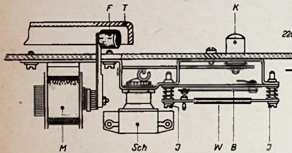
Bild 3. Schematische Darstellung des Pausenschalters mit Bremsmagnet
