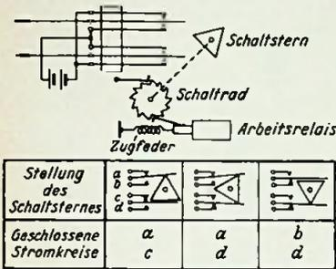
Bild 12. Für Schiffmodelle geeigneter Schrittschalter
