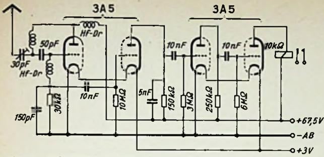
Bild 10. Mehrröhrenempfänger unter Verwendung von zwei Batterie-Doppeltrioden
