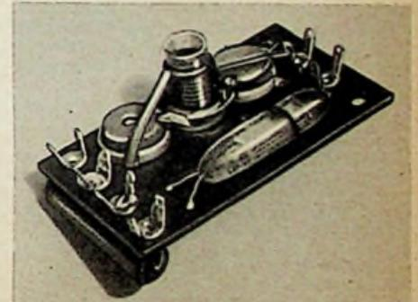
Bild 5. Ausführungsform des Einröhrenempfängers nach Bild 4
