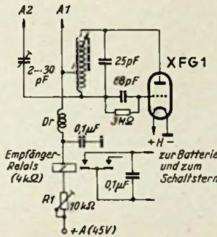
Bild 4. Vereinfachte Schaltung des Einröhrenempfängers nach Bild 2
