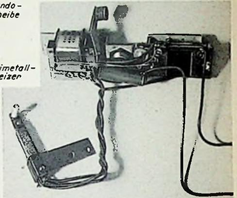
33 1/3, 45 und 78 U/min festgelegt —, um so langsamer dreht sich T. Eine Zugfeder F, die an P so eingehängt ist, daß sie A gleichzeitig an W und T drückt, hält die ganze Hebelanordnung in Arbeitslage, also so, daß die Friktionsstellen stets in sicherem Eingriff bleiben.
