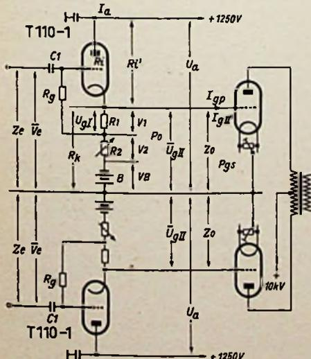
Bild 5. Gegentak-B-Modulator mit niederohmiger Treiberstufe in Katodenfolgeschaltung
