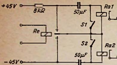
Bild 19. Kondensatorsteuerung mit zwei Funktionen. Wird der Sender kurz eingeschaltet, arbeitet Relais 1; wird er kurz ausgeschaltet, dann zieht Relais 2 an
