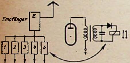
**Bild 4. Mehrkanalsteuerung mit fünf Nf-Oszillatoren.** Die in den Resonanztransformatoren des Empfängers erzeugten Wechselströme werden gleichgerichtet und schalten über ein Zwischenrelais den Arbeitsstromkreis
