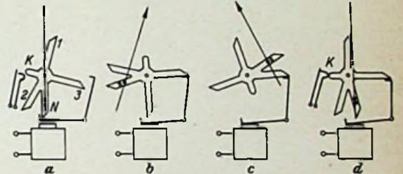
Bild 16. Arbeitsrelais System „Bonner“, USA. Die Zahnradvermessung verlangt eine Kurbelumkehrung auf 1 sec. Dadurch wird eine einwandfreie Impulsgebung erzeugt
