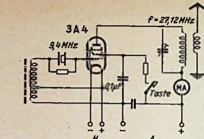
**Bild 2. Quarzgesteuerter Hf-Sender mit Frequenzverdreifung**
